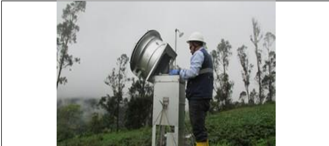
Fotografía 3-12 Cambio de filtros de PM10 en la estación de monitoreo 5 Finca El Consuelo, municipio de Machetá
