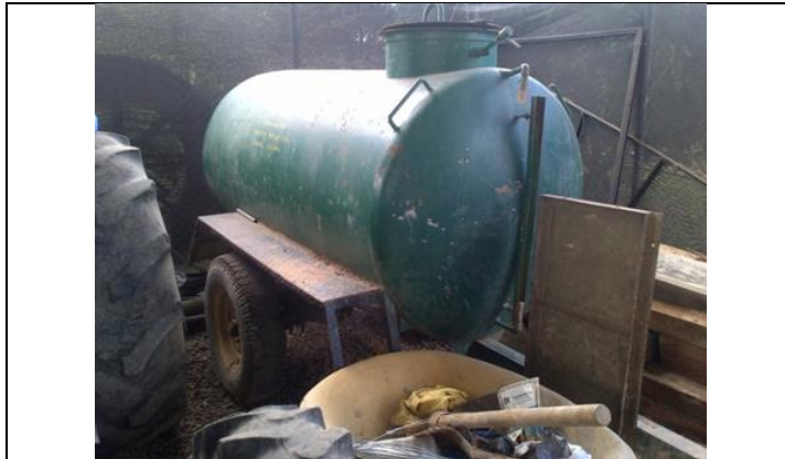
Fotografía 4-1 Tanque para el Transporte de Agua a sitios de torre
